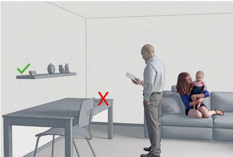
Platzieren Sie freistehende CO-Warnmelder so, dass Beschädigungen durch Umstoßen vermieden werden. Um eine dauerhafte Beschädigung des CO-Warnmelders zu vermeiden, muss ein freistehender Melder so aufgestellt werden, dass es unwahrscheinlich ist, dass er umgestoßen wird. Im Wohnbereich ist der Melder in Kopfhöhe der am häufigsten anwesenden Personen anzubringen.
