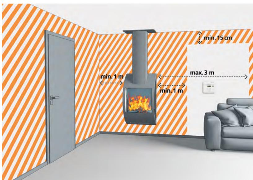
Bei einer Wandmontage sollte der Melder in Deckennähe angebracht werden. Der Mindestabstand beträgt 15 cm, damit wird verhindert, dass sich der Melder an einer unbelüfteten Stellen befindet. Der Melder muss zudem in einem horizontalen Abstand von mindestens einem Meter, jedoch maximal drei Meter von einem brennstoffbetriebenen Gerät (CO-Quelle) angebracht werden.
